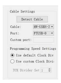
注意:在 Windows10由于串口初始化,会导致 FTUSB-0和 FTUSB-1顺序错误,必须确认在 A 通道。对于新版本的 HW-USBN-2B,直接选择 FTUSB-0就可以。
