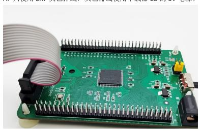
B. 使用 DC 和单端线缆。此类可以兼容其他的 2A 下载器。2B 下载器线缆也可以支持。 DC 插入电源电压是 5V, 线缆根据定义插入, VCC, TDO, TDI, TMS, TCK, GND。
